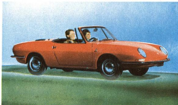
für einen sportlichen Flitzer gehört, das Armaturenbrett ist mit dunklem, reflektionsfreiem Kunststoff bezogen und, dank seiner großen Instrumente, übersichtlich und bequem. Die Spitze? 135 km/h! Für einen Motor mit 843 ccm, der bei 6200 Umdrehungen 47 PS leistet, eine tolle Geschwindigkeit! Der Preis? 6300 DM ab Werk. Das
