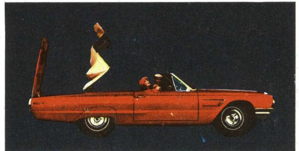
Ein Blick auf den Thunderbird mit elektrisch betriebenen Faltdach. Man drückt einfach auf einen Knopf, es öffnet sich der Kofferraum und das Verdeck verschwindet schnurrend darin. 190 km/h macht der V-8-Motor, der auf 100 km gut und gern 19 Liter Super schluckt.
