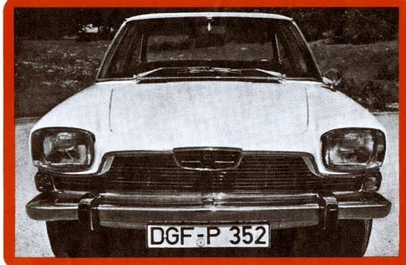
Mit einem (sehr) kleinen Luftschiff kann sich auch fast die Höchstgeschwindigkeit des GLAS 3000 messen: Man kann mühelos eine Spitze von 200 Stundenkilometern herausfahren. Well, wenn ein Auto 160 Pferdestärken mitbekommen hat, darf man schließlich einiges von ihm verlangen! Auch die Beschleunigungszeiten können sich sehen lassen: In 9 Sekunden von 0 auf 100 km/h, in der vierfachen Zeit ist er schon auf 180 km/h.
