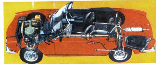
fünf Vorwärts- und einen Rückwärtsgang. Der fünfte ist ein "Schnellgang", der schon bei 60 km/h eingeschaltet werden kann. Damit spart man Benzin und erreicht eine noch
